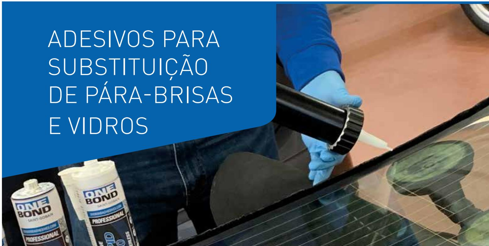
As colas para vidros são amplamente utilizadas na instalação e substituição de para-brisas, faróis traseiros, vidros e outros vidros de automóveis, incluindo tectos de abrir e tectos panorâmicos. São normalmente adesivos de componente único à base de poliuretano ou MS híbrido.
